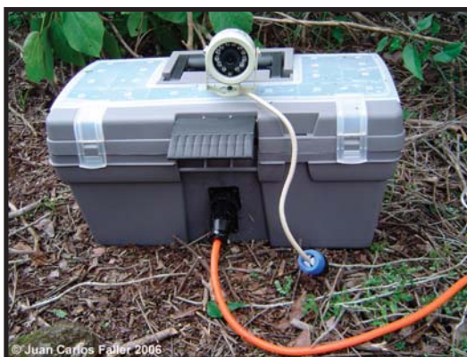
Figura 2. Prototipo de video-cámara usado para la filmación de jaguares en el norte de Yucatán.
